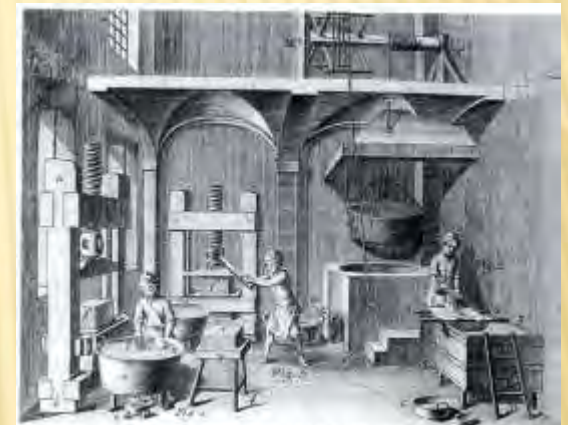
« Papetterie, colage », planche XI de l'Encyclopédie (détail).
